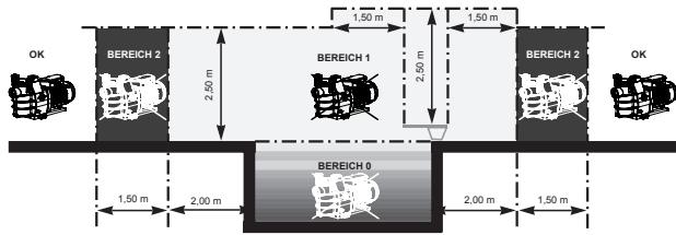
Pumpe an einem belüfteten, trockenen Ort aufstellen. Für einen ordnungsgemäßen Betrieb des Motors muss die Luft frei um die Pumpe zirkulieren können, um ihn auf natürliche Weise zu belüften. Regelmäßig prüfen, ob Gegenstände, Blätter oder andere störende Objekte die Motorkühlung verstopfen.
