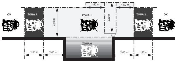
Instalar a bomba num local ventilado e seco; o motor precisa que o ar circule livremente à volta da bomba para permitir a sua ventilação natural. Verificar regularmente que objectos, folhas ou quaisquer outros elementos não obstruem a refrigeração do motor. A bomba deve ser instalada de forma a que o interruptor exterior de desligação que está integrado na caixa fixa esteja visível e facilmente acessível. O interruptor deve estar situado perto da bomba.
